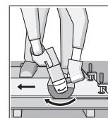
必须逆着机器的转向推动电动工具，否则容易失控，导致电动工具从切线中滑出。切割型材和方管时最好使用最小的截面。
